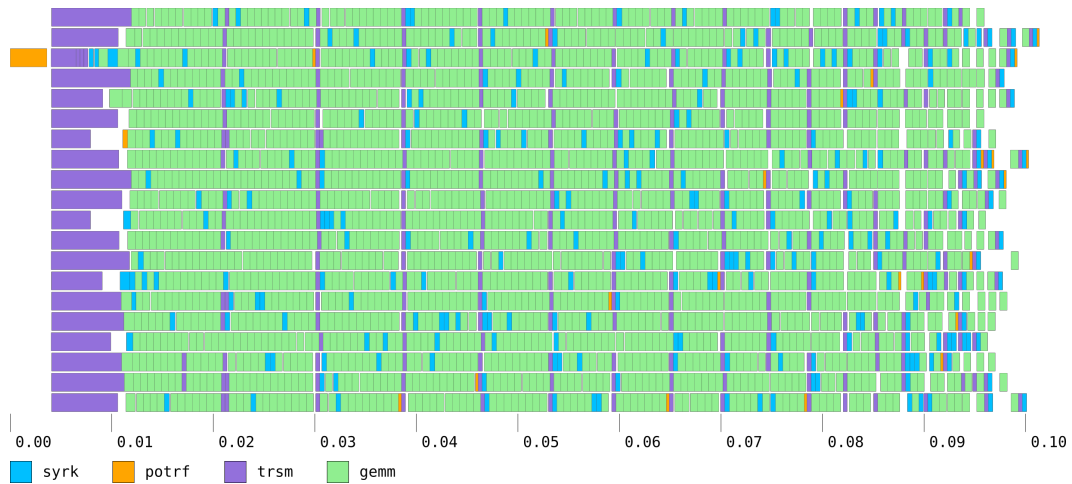
Figure 11.1: Trace of plasma_dgetrf() on Haswell: numactl --interleave=all ./test dgetrf --dim=6144 --nb=192 --ib=28 --mtpf=4
